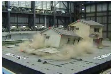
倒壊比較（未補強住宅が全壊）
