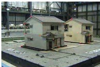
倒壊比較（右が補強済、左が未補強）
